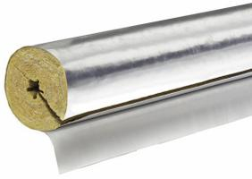
Steinwolle-Rohrschale passend für unterschiedliche Rohrdurchmesser mit einer UV resistenten, glasfaserverstärkten Mehrschichtverbundfolie in Aluminiumoptik kaschiert, die durch eine selbstklebende Überlappung verschlossen wird.
